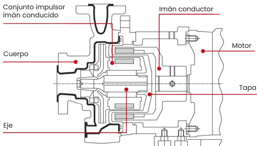
Desde el punto de vista del diseño, la principal ventaja de una bomba de acople magnético frente a una convencional con sello mecánico o empaquetadura es la ausencia de eje sólido que transmita potencia entre el motor y el impulsor de la bomba. Al no existir eje pasante, no es necesario disponer de un sistema de sellado que aísle el fluido en el interior de la bomba de la atmósfera evitando pérdidas.
